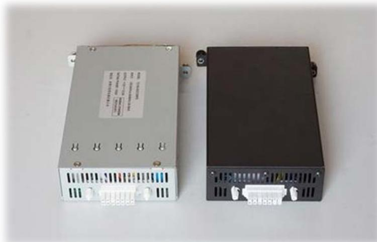
Для резервирования питания используется внешний аккумулятор с емкостью до 100Ач (рекомендуемая 20...60Ач). Помимо емкости АКБ следует учитывать время заряда. К примеру, севший аккумулятор 40Ач зарядится за 15-20 часов.
